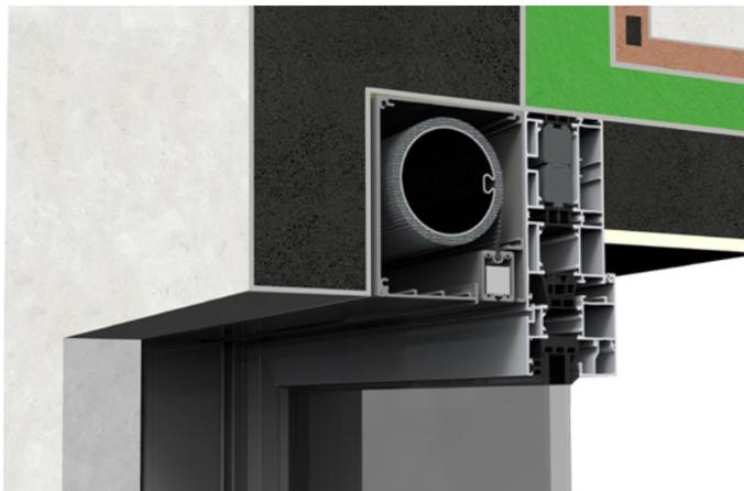
**ZIP Screen rolo NOTO** ist das fortschrittlichste ZIP-Screen-System auf dem Markt! Es eignet sich sowohl für Aufputz- als auch Unterputzmontage, bei der sowohl der Kasten als auch die Führungen in die Fassade integriert werden können. Eine besondere Eigenschaft des Systems NOTO ist die Abschlussleiste, die sich vollständig im Kasten verbirgt und so zur perfekten Optik des Gebäudes beiträgt.
