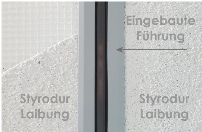
Die Unterputzjalousie **ADUT-S** eignet sich ebenfalls für Neubauten und Sanierungen, unterscheidet sich jedoch durch eingebaute Führungen in Styrodur-Ausführung. Vor der Fassadenerstellung wird der Jalousiekasten eingebaut, und Styrodurlaibungen mit Aluminiumkanal für die Führungen werden geliefert.
